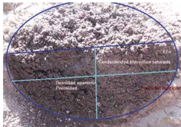
Figura 2. Representación de la zona no saturada y sus características del suelo
